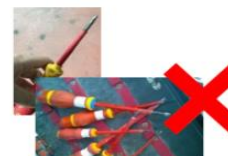
Tournevis à isolant dégradé
